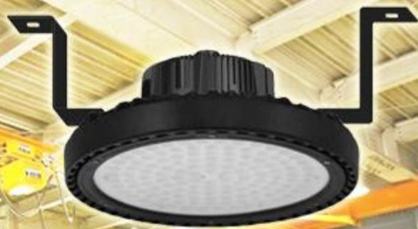
HD300T9Cシリーズはクレーン用照明として設計された、水銀灯1000W-1200Wに相当する高出力LED投光器です。クレーン取り付け用の特殊形状9mm厚ブラケットを採用し、現行クレーン照明の置き換えを容易にしています。
