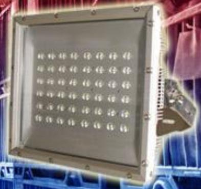
環境試験室用LED照明 PH-T-LHTシリーズは、低温・高温両用のLED照明です。常時通電回路により電源OFF時にも微量の電流を流すことで冷却による電子部品の劣化を保護して、-100℃の環境での使用を可能にしています。また、従来の高温用PH-Tシリーズと同様に高温環境下での使用も可能な特殊設計になっていますので、超低温から超高温までのすべての温度環境で使用可能です！
